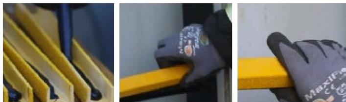
Leitersprossenabdeckungen können mit einem Orbitalschneider mit Diamantklinge auf die gewünschte Größe zugeschnitten werden. Das Schneiden sollte nur im Freien erfolgen, wo Staubabsaugung oder geeignete Belüftung vorhanden sind und die entsprechende Schutzausrüstung getragen werden sollte. Eine Stichsäge kann zum Zuschneiden oder für Gelegenheiten verwendet werden, bei denen nur wenig geschnitten werden muss.
